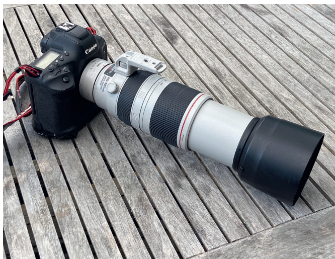
En 1,4 gångers telekonverter (extender) påkopplad mellan kameran och ett 100-400 mm zoomobjektiv förlänger brännvidden till 140-560 mm. Foto: Mikael Arinder.
